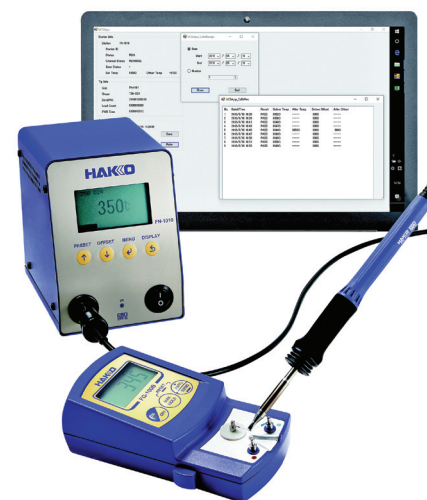
Obr. 2 Kalibrace IoT stanice. Měření reálné teploty pájecího hrotu a přenos hodnoty díky infra senzoru do stanice a následná kalibrace
