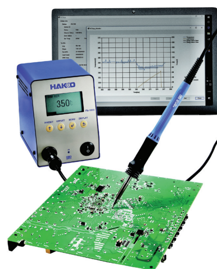
Obr. 1 IoT stanice sleduje pracovní teplotu, spotřebu energie, model pájecího hrotu, sériové číslo, počet pájených bodů, čas pájení atd.
